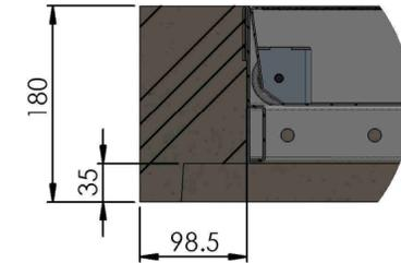
Bis 3cm Betoniert für modularer Schacht
