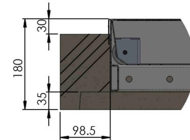
Bis 3cm Betoniert ohne Schacht
